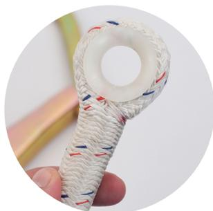
El empalme con gaza para la confección de los ojos en las terminaciones, es el método preferido para terminar una cuerda. Los nudos pueden reducir significativamente la resistencia de una cuerda, mientras que, este empalme mantiene el 100% de la resistencia especificada de la cuerda.
